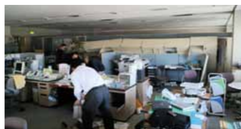
仙台にある日東電工 東北支店の事務所内。キャビネットは壁に固定していましたが、それを上回る揺れのため、倒れました。
