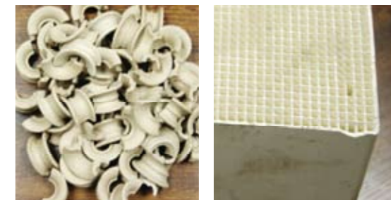
写真左がサドル形状の蓄熱体、右がモノリス型セラミックハニカム蓄熱体
