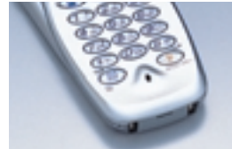
●フッ素樹脂多孔質膜 (マイクロテックス) 空気を通し、水をはじく選択透過性を利用し、携帯電話の通気孔に使用するほか、自動車のランプユニットにも用いられています。
