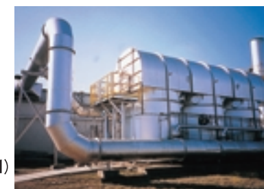
パーマセル(米・ニュージャージー州)の蓄熱式脱臭炉
