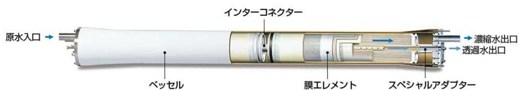
図2 膜モジュール及びベッセルの構成
