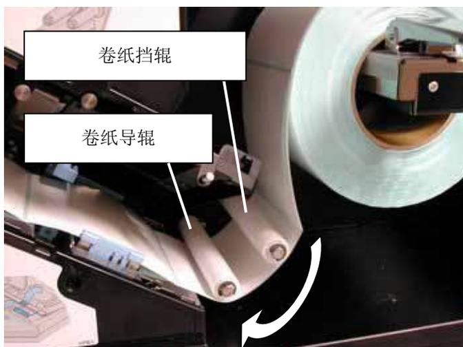
7. 在印刷面内卷的情况下，需要将打印纸先从卷纸挡辊的上部穿过，然后再从卷纸导辊的下侧穿过。
