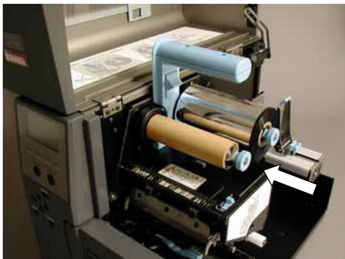
7. 将新的墨带辊筒的端部剥开。拉出墨带并穿过上部组件的下侧，然后将墨带辊筒的端部（附着有粘结材料）粘贴到墨带卷芯上。
