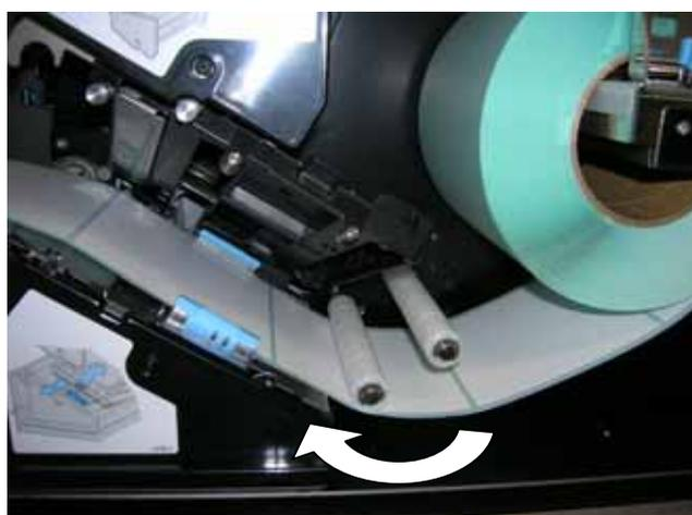
8. 调节进纸导向板，使之与打印纸的幅宽相匹配。
